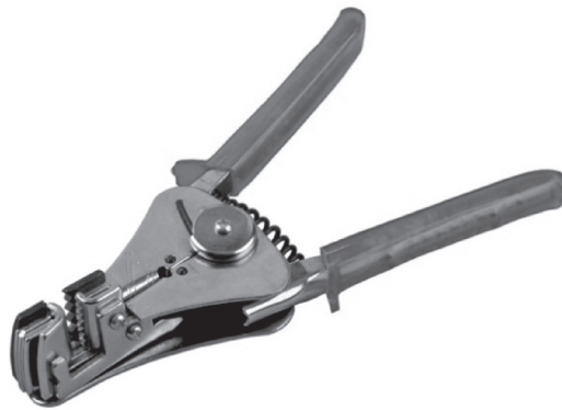
Рисунок А.4 – Клещи для снятия изоляции
