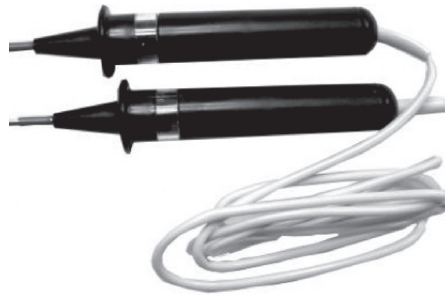
Рисунок А.3 – Указатели низкого напряжения
